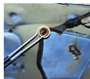
› Zur einfachen Entfernung von kleineren Verkleidungen
