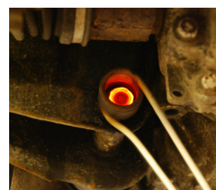
› Zum Erwärmen und Lösen von festsitzenden und angerosteten Teilen
