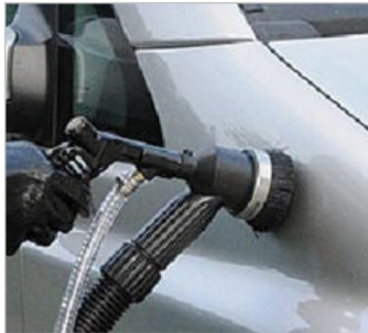
• Strahlmittel wird nach dem Auftreffen auf die Oberfläche sofort wieder abgesaugt und zurückgeführt
