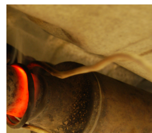
› Zum Lösen von schwer zugänglichen Teilen durch den Einsatz von speziellem Wickeldraht
