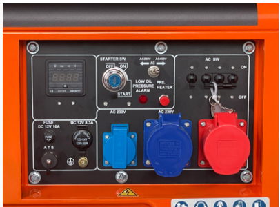
Steckdosenausführung 1x 230 V 16A Schuko 1x 230 V 32A CEE 1x 400V 32A CEE 1x 12 V DC
