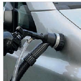
▶ Strahlmittel wird nach dem Auftreffen auf die Oberfläche sofort wieder abgesaugt und zurückgeführt
